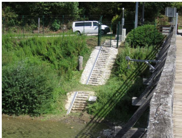
Slika 10. Hidrološka postaja Kolpa Sodevci. Merilno mesto je opremljeno z vodomerno letvijo, avtomatskim tlačno-temperaturnim in radarskim senzorjem za izvajanje meritev pretoka in temperature vode (foto: arhiv ARSO).
