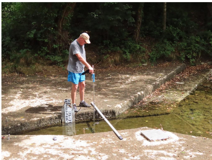
Slika 1. Izvajanje meritve zelo nizkega pretoka Rižane v Kubedu 18. avgusta 2022 (Foto: arhiv ARSO) Figure 1. Very low discharge measurement of Rižana in Kuba on 18 of August 2022 (Photo: ARSO archive)
