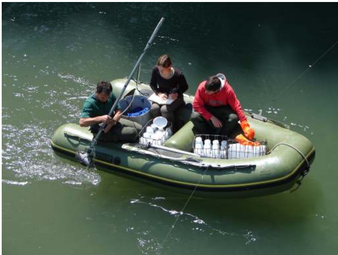
Slika 7. Izvajanje sočasnih profilnih meritev pretoka in vsebnosti suspendiranega materiala na postaji Suha, junij 2006 (foto: Florjana Ulaga)
