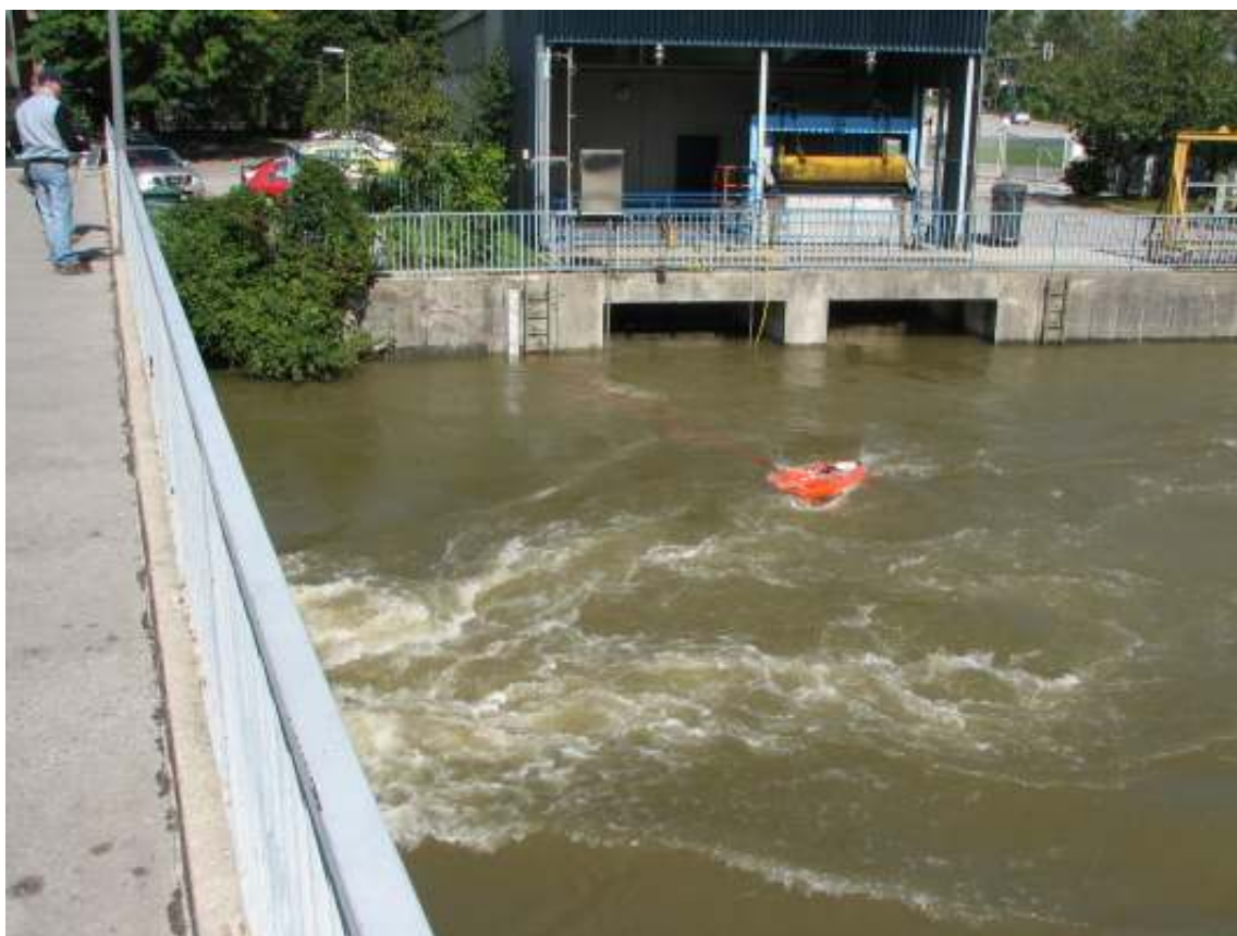
Slika 4. Izvajanje meritve pretoka na vodomerni postaji Moste ob visoki vodi septembra 2010 (foto: Arhiv ARSO)
