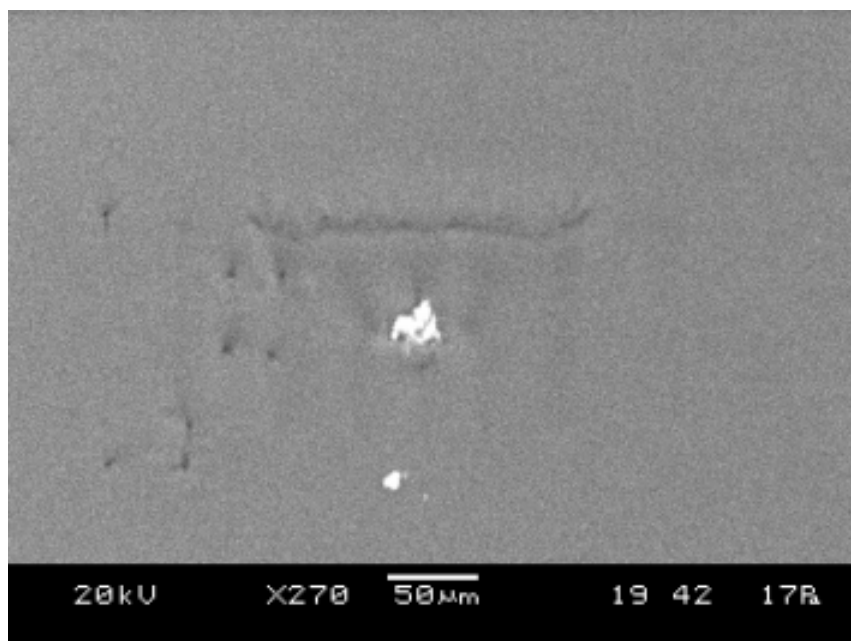
Slika 5. SEM mikroposnetek aglomerata vulkanskega prahu (trak z oznako "7000") Figure 5. SEM micrograph of a volcanic dust agglomerat
