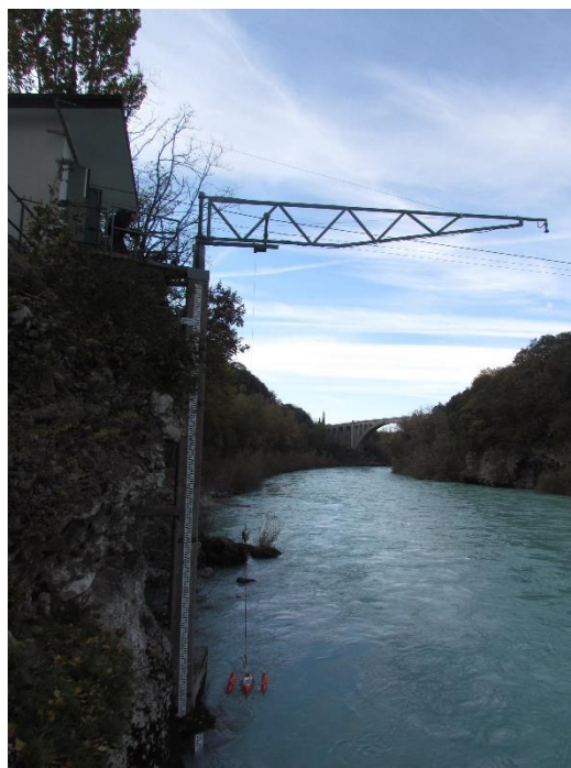
Slika 2. Hidrološka postaja Soča Solkan. Merilno mesto je opremljeno z vodomerno letvijo, avtomatskim tlačno-temperaturnim in radarskim senzorjem ter žično premostitvijo za izvajanje meritev pretoka. Merilno območje sega od 140 do 1260 cm višine (foto: arhiv ARSO). Figure 2. Gauging station Soča Solkan (Photo: ARSO archive)
